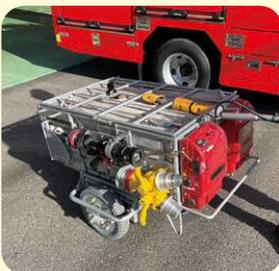
防火水槽や消火栓が消防車から遠い場所にあるときに活躍します。長い距離を伸ばせるように10本のホースが積載されています。最大で200メートル延長することができます。
